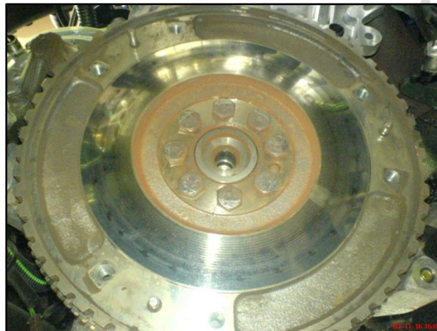
شکل شماره (۳۷) آینه شدگی ( براق شدگی ) سطح فلاپویل
