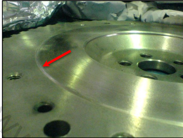
شکل شماره (۳۸) خوردگی و پله شدگی سطح فلاپویل
