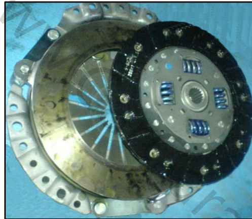
شکل شماره (۲۲) وجود روغن روی سطح دیسک و صفحه کلاچ
